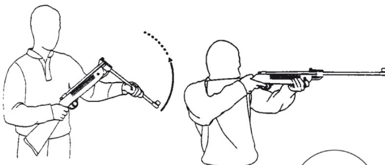
Fermez le canon après le chargement d'un projectile, ce faisant un claquement explicite doit être perceptible; à ce moment-là le canon est verrouillé correctement. Après qu'on a ôté la sûreté la carabine à air est maintenant prête à tirer.
