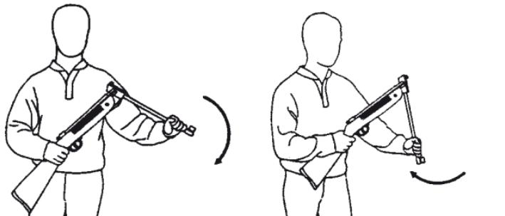
Laden Sie vor dem Schuß ein Diabolo in das Geschosslager und drücken es mit dem Daumen so tief ein, dass es bündig oder etwas tiefer mit dem Laufende liegt.
