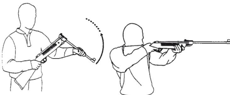
Nach dem Laden eines Geschosses schließen Sie den Lauf, dabei muss eindeutiges Klicken hörbar sein; der Lauf ist dann richtig verriegelt. Nach dem Entsichern ist das Luftgewehr jetzt schussbereit.
