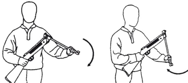
**Attention:** Ne laissez pas quelque part la carabine à air comprimé avec le piston armé pour un plus long temps. Cela peut mener à des accidents et en plus le ressort du percuteur peut fatiguer provoquant des dommages au niveau du rendement de tirs de l'arme.
